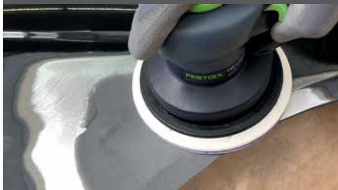
Za glatku površinu brusite proizvodom 3M™ Cubitron™ II 80+ (51369) do 120+ (51370). Sledite korake u sledećem postupku brušenja.
